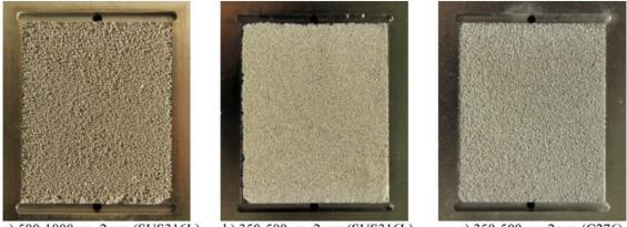
a) 500-1000µm, 2mm (SUS316L) b) 350
