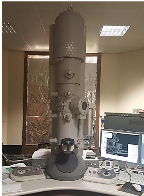
Figure 3.3: TEM instrument model: Tecnai G2-F20 S-TWIN
