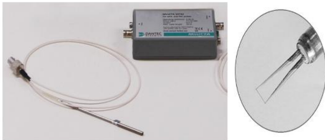
Figure 27. The mini CTA hotwire anemometer (model 54T42) [178]
