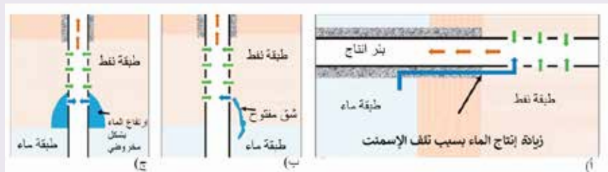
شكل (1): أمثلة لمصادر زيادة إنتاج الماء من بئر إنتاج النفط (أ) تسرب الماء نتيجة تلف الإسمنت، (ب) منطقة بها شقوق مفتوح، (ج) تجمع الماء في شكل مخروطي بسبب معدل الإنتاج المرتفع (المصدر: (Taha & Amani, 2019)
