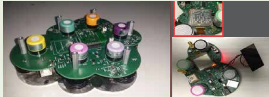
الشكل (2): عرض ثلاثي الأبعاد لـ SERENO (عرض علوي للوحة الدارة المطبوعة)، حيث يتم عرض مستشعرات الغاز 6 (الإصدار 1، الجانب الأيسر) أو 4 (الإصدار 2، الجانب الأيمن). يتميز الإصدار 2 بعرض محلياً.
