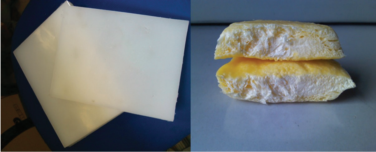
الشكل (1): في اليمين «الكُتل الرغوية»، وفي اليسار المواد مُتغيرة الطُّور المكوّنة من مادة خليط شمع البولي إيثيلين والبارافين «الكُتل».
